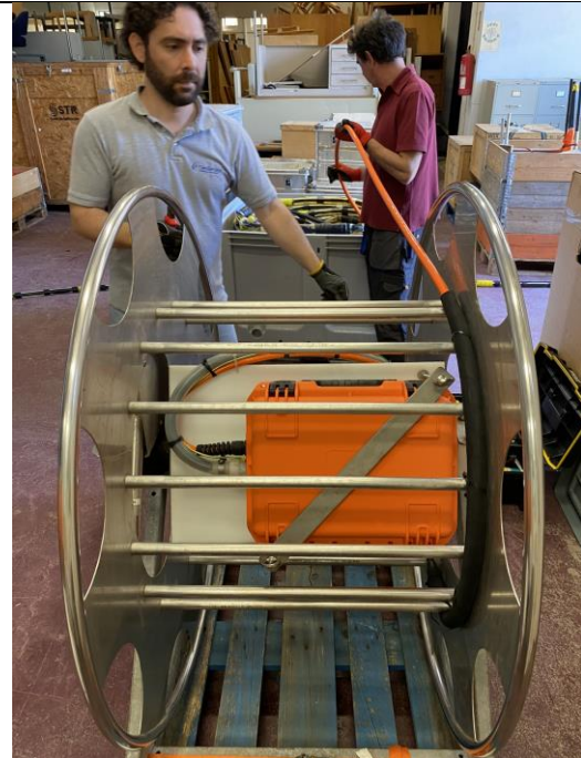
Foto IV.02 - Desmontagem da streamer antiga do guincho manual
