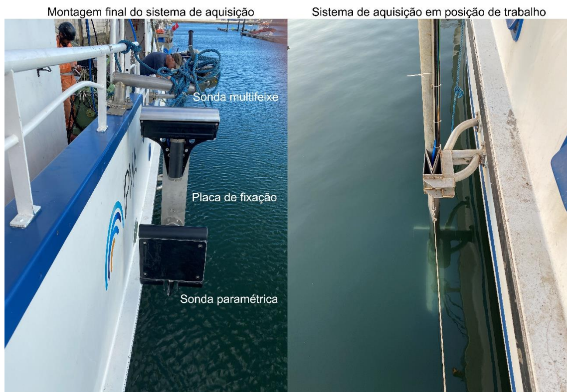
Figura 5. Montagem conjunta dos transdutores dos sistemas MBES+TOPAS em poste lateral. Imagem esquerda vista da proa para a poupa e imagem direita vista da poupa para a proa. Figure 5. Joint assembly of the transducers of the MBES+TOPAS systems on a side pole. Left image view from the aft to bow and right image view from bow to aft
