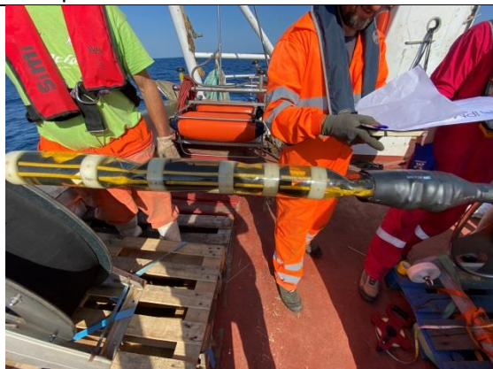
Foto IV.09 - Estrangulamentos junto da "boot section" da nova streamer
