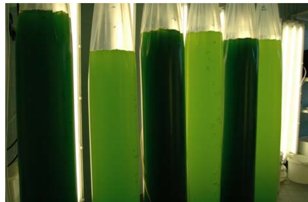
Figura 8 – Crescimento de Nannochloropsis oculata , respectivamente, com e sem utilização de 1% de CO 2 juntamente com o arejamento.
