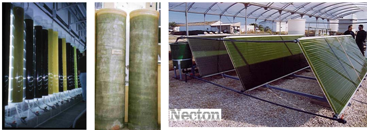
Figura 18 – Fotobiorreactores - Tubos de acrílico e de fibra de vidro translúcida e painéis para a produção de microalgas.
