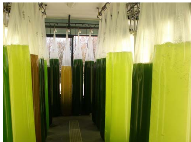
Figura 14 – Tubo de acrílico para produção de microalgas.
