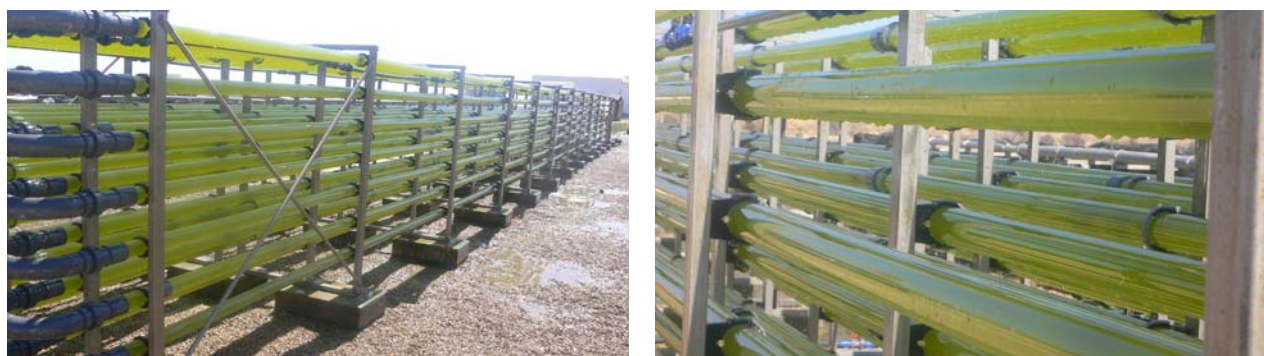
Figura 19 – Fotobiorreactor tubular (Necton – Olhão, Portugal).
