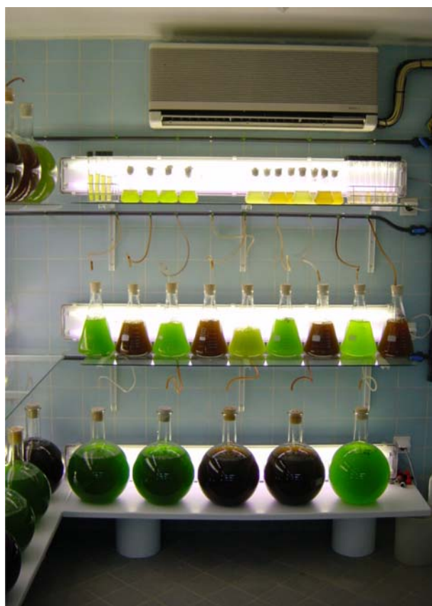
Figura 12 – Sala de manutenção de inóculos de microalgas. Tubos de ensaio (40 mL), erlenmeyers (250mL e 2 L) e balões (10L).
