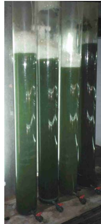
Figura 14 – Tubo de acrílico para produção de microalgas.
