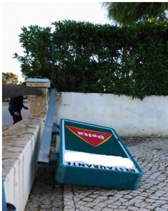
Fig B – Detalhe de um sinal com suporte de secção retangular, completamente dobrado (Ponto 2, Fig 1).
