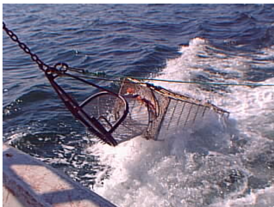
Figura 2 – Ganchorra de grelha, mostrando a boca e a grelha de retenção.
