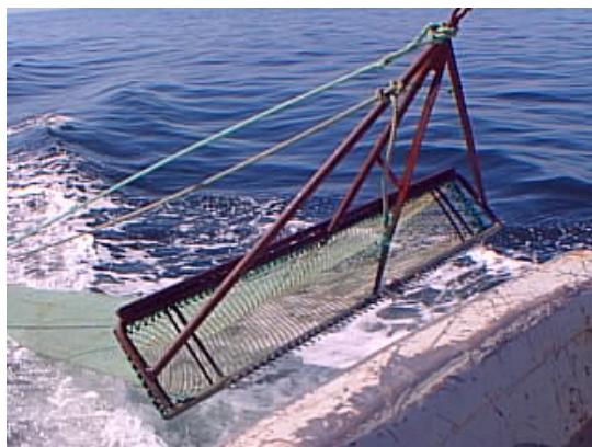
Figura 1 – Ganchorra do norte, mostrando a boca e o respectivo saco de rede.
