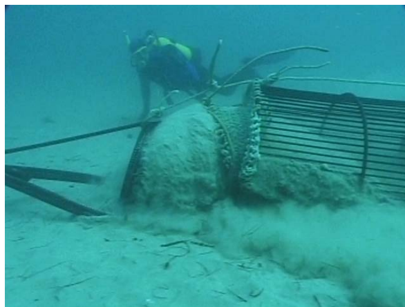
Figura 7 – Ganchorra de grelha durante o arrasto.
